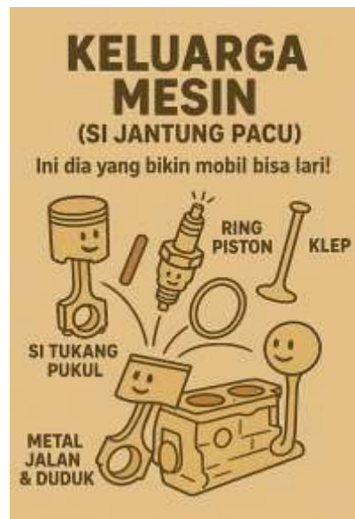
Gambar 1. Karikatur Keluarga Mesin untuk Memperkenalkan Komponen Utama Mesin Kendaraan
