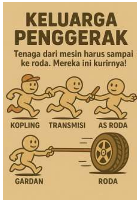
Gambar 2. Karikatur Sistem Penggerak untuk Menjelaskan Alur Penyaluran Tenaga dari Mesin Menuju Roda
