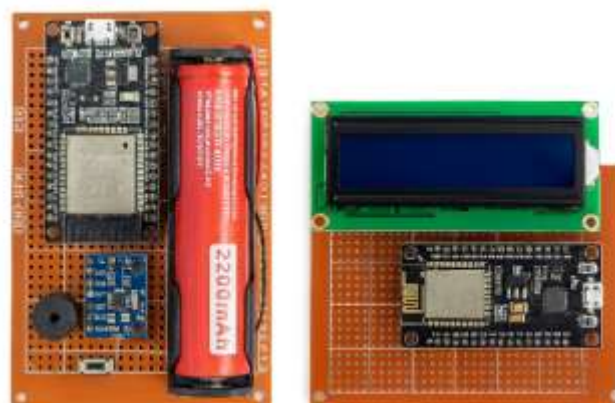
Gambar 4. Bagian-bagian komponen hasil rancangan yang telah disusun di PCB
